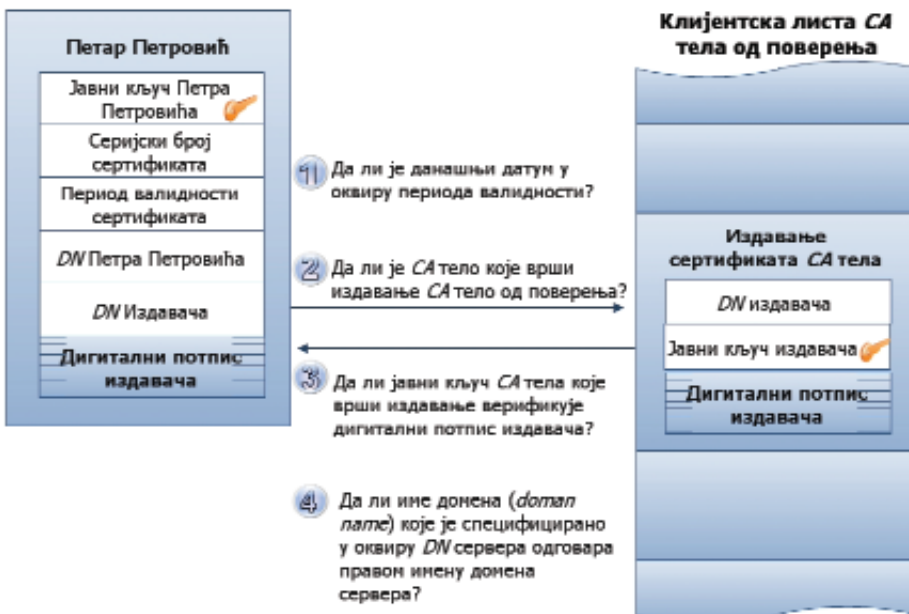
Шема 2. Поступак SSL аутентикација сервера
