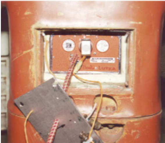
Слике 6 и 7. Компоненте аналогног аквизиционог система, фото-регистратор и мерни претварачи, постављени у падобранску лутку
