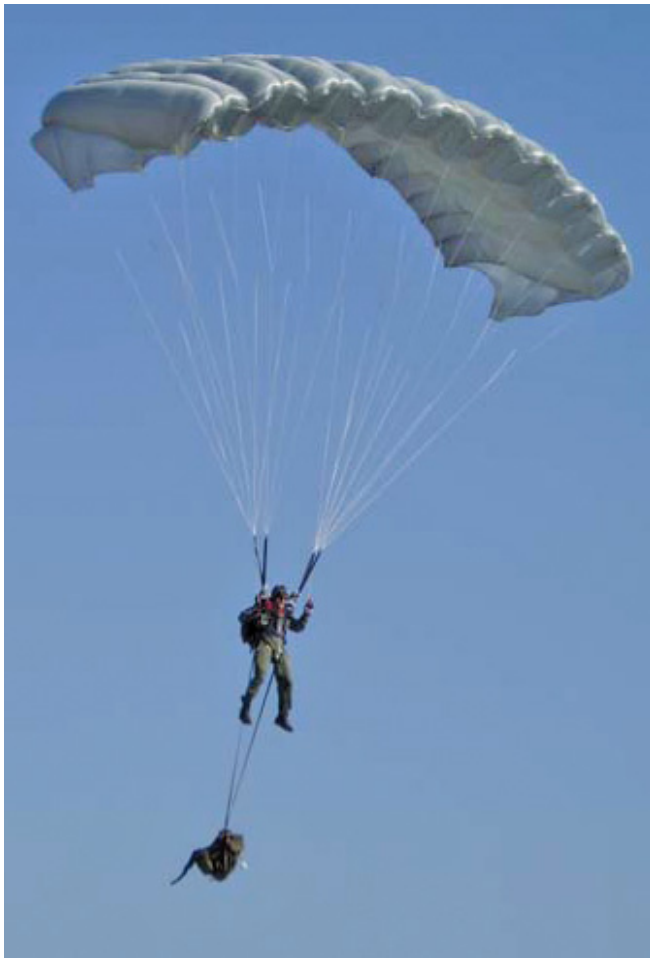
Слика 1. Испитивање школско-борбеног падобрана УМ-1 са торбом за терет. Падобранац је опремљен дигиталним аквизиционим системом.
