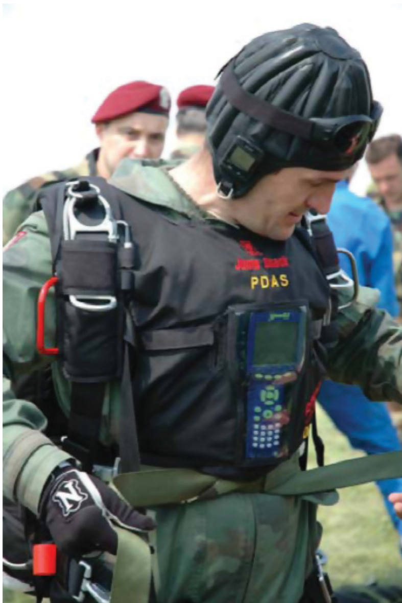
Слика 9. Дигитални аквизициони систем постављен на падобранца
