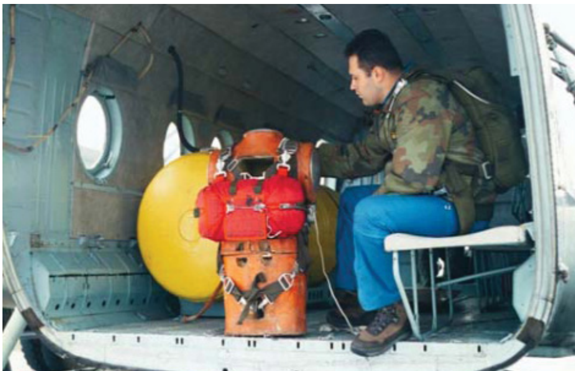
Слика 2. Падобранска лутка припремљена за бацање из хеликоптера
