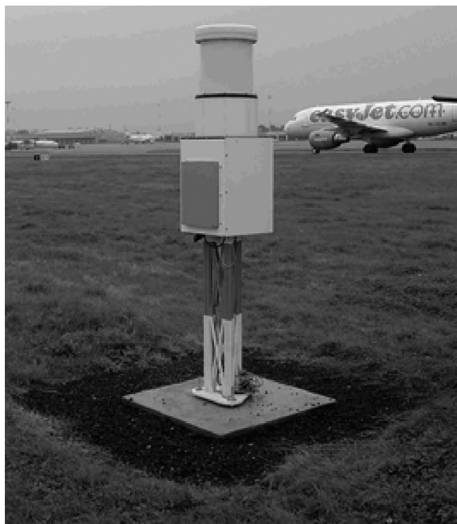
Слика 1. Радар „DSMR800 millimetric radars“ инсталиран на аеродрому
