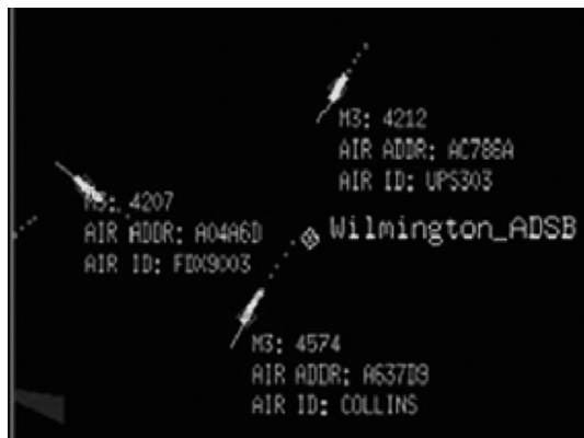
Слика 4. Систем аутоматског зависног надгледања и емитовања података
