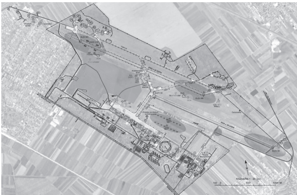
Слика 7: Пример дела решења орнитолошког обезбеђења на аеродрому Батајница: црвено – зоне постављања уређаја за плашење птица, жуто – зоне постављања шилјака за спречавање слетања птица, плаво – зоне исушивања водених површина и уклањања депонија, зелено – зона могућег гајења усева. Унутар рејона аеродрома висина траве може бити од 15 до 35 cm
