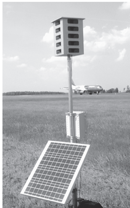
Слика 5: Bird Gard Super Pro Amp стационарни аутономни уређај за плашење птица
