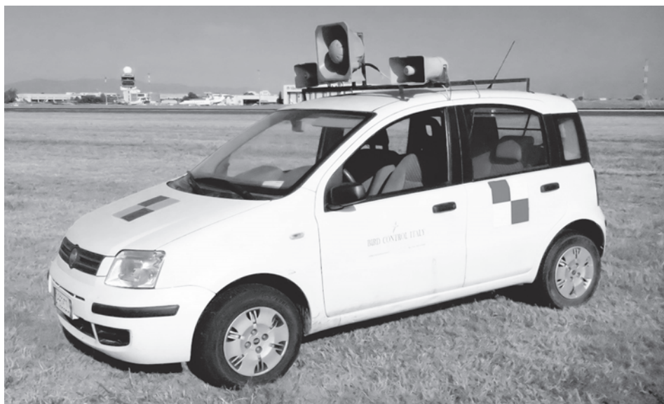
Слика 4: Мобилна јединица за орнитолошко обезбеђење на једном од италијанских цивилних аеродрома
