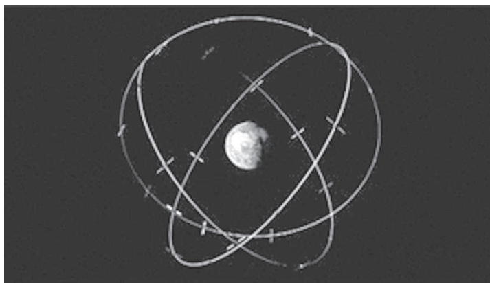
Слика 3. Приказ сателита (Galileo) за позиционирање објеката на Земљи
